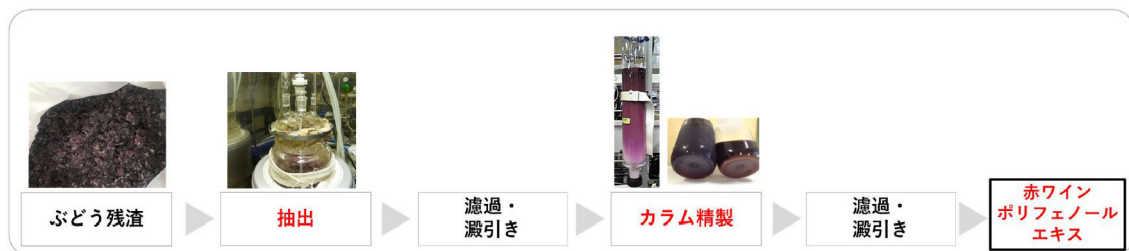
図1. 「赤ワインポリフェノールエキス」の製造工程
