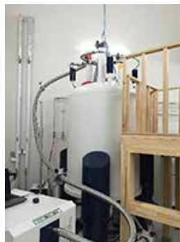
800MHz超伝導核磁気共鳴分析装置
