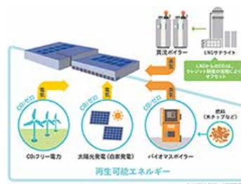
サントリー天然水 北アルプス信濃の森工場における CO 2 排出ゼロの仕組み
