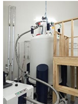
800MHz超伝導核磁気共鳴分析装置
