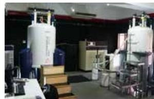
超電導核磁気共鳴分析装置
