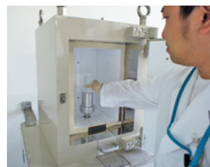
放射性セシウムを精密に測定することが可能なゲルマニウム半導体検出器
