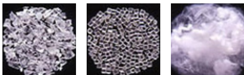
フレーク ペレット ペット再生綿
