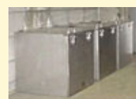
PCB廃棄物の保管容器
